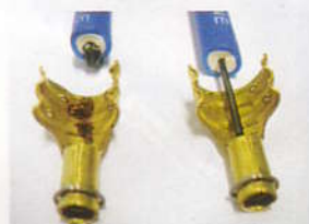
Tańsze (z lewej) i droższe (z prawej) końcówki przewodów węglowych
