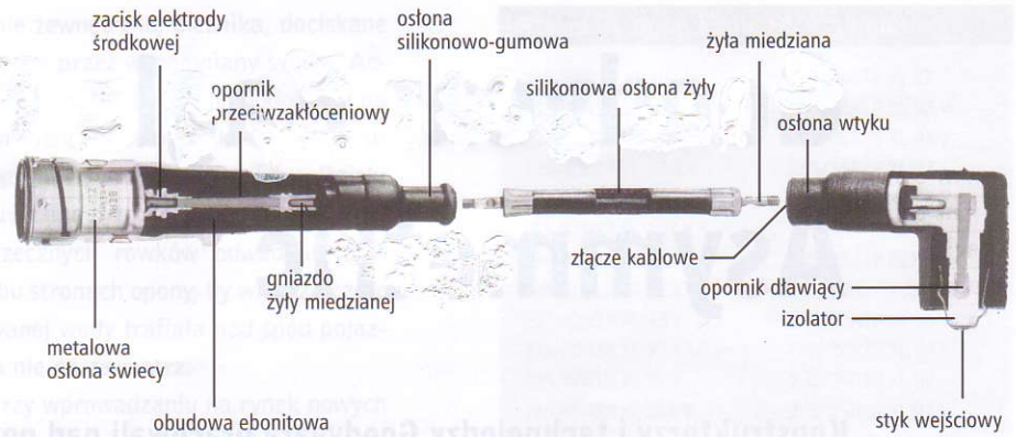
Budowa klasycznego przewodu zapłonowego z żyłą miedzianą
