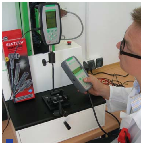
Pomiar siły montażu, demontażu i wrywania końcówek oraz jakości połączenia końcówki z kablem.
